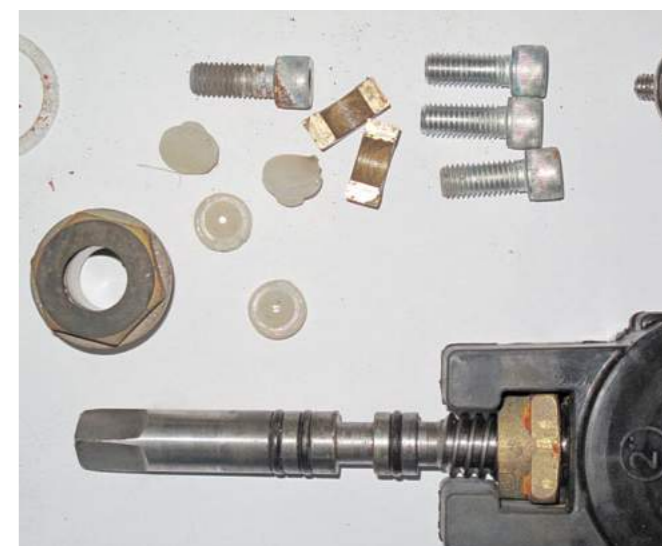
Диаметр вала задвижки Образца №1 составил 18 мм (замерено штангенциркулем в редакционных условиях), что подтверждается табличными данными у производителя
