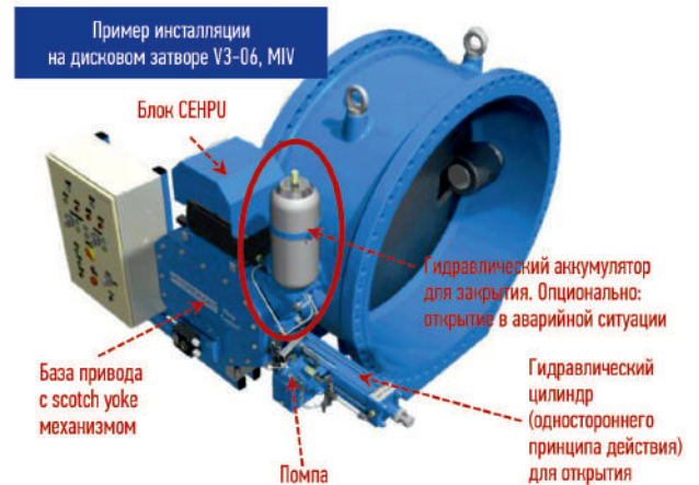
Рисунок 3 — Дисковый затвор MIV V3-06-3E с гидравлическим приводом HYDROMAT с опциями в виде маслостанции, помпы и аккумулятора
