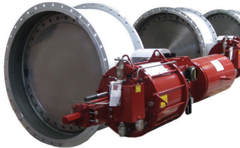
Рисунок 1 — Пневмопривод (закрытие пружиной) 3-х эксцентрикового затвора DN 1500 PN 2,5. Фактическая скорость закрытия при тестировании на заводе около 1,5 сек., при этом арматура была закрыта на 85 % за время 0,8 сек.
