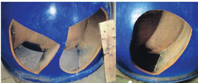
Рисунок 11 — Поврежденный обратным потоком насос (трубопровод Ду2000).
