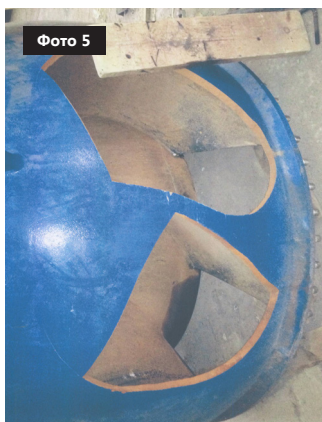
Фото 1-6. Последствия некорректной работы защитной арматуры
