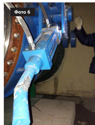
Фото 1-6. Последствия некорректной работы защитной арматуры
