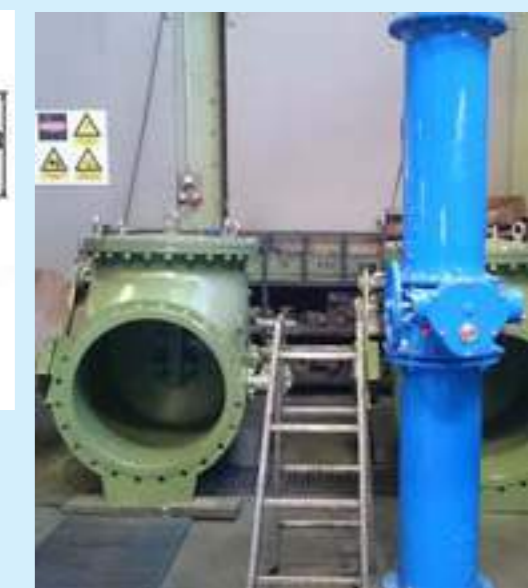
Рисунок 4 Правильный обратный (невозвратный) клапан (тип V2-08, производитель – MIV) с правильным креплением диска к валу
