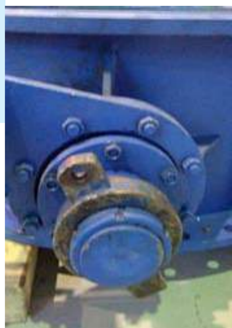
Рисунок 1 – Обращают на себя внимание «тонкие» рычаги с грузом, хлипкость внешних элементов корпуса арматуры, а именно кронштейна демпфера. Конструкция соединения амортизатора с валом, крепление амортизатора исключительно неудачные. Изначально очевидно, что выжить кронштейну при демпфировании маловероятно, что и подтвердилось практически при первом срабатывании
