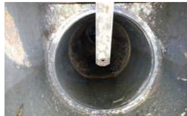
Рисунок № 3 – Неправильное крепление диска к валу у неправильного клапана и плачевный результат
