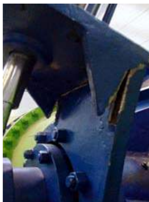
Рисунок 1 – Обращают на себя внимание «тонкие» рычаги с грузом, хлипкость внешних элементов корпуса арматуры, а именно кронштейна демпфера. Конструкция соединения амортизатора с валом, крепление амортизатора исключительно неудачные. Изначально очевидно, что выжить кронштейну при демпфировании маловероятно, что и подтвердилось практически при первом срабатывании
