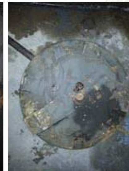
Рисунок № 3 – Неправильное крепление диска к валу у неправильного клапана и плачевный результат
