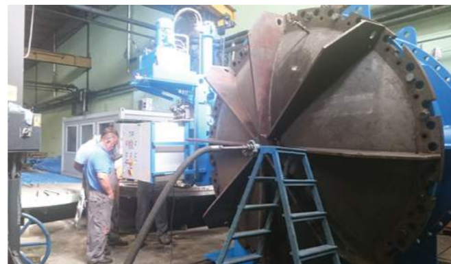
Рисунок 14 — Гидравлическое испытание затвора рабочим давлением воды 6,6 атм. на герметичность седла
