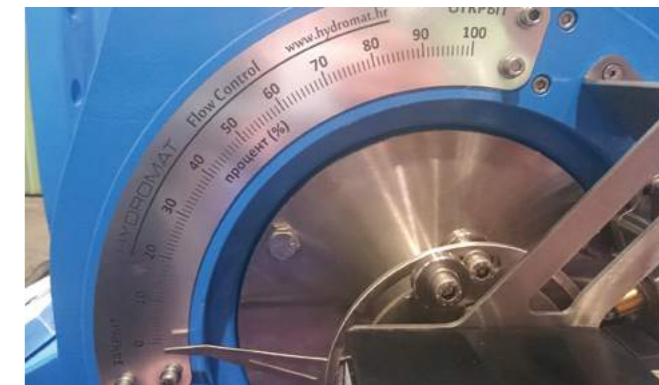
Рисунок 21 — Механический указатель со шкалой открытия, значение которой четко идентифицируется и синхронизировано визуально со значением на сенсорном экране
