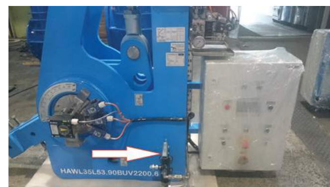
Рисунок 11, 12, 13 — Привод HAWL со шкафом управления. Белой стрелкой указано место расположения ручного насоса (помпы)
