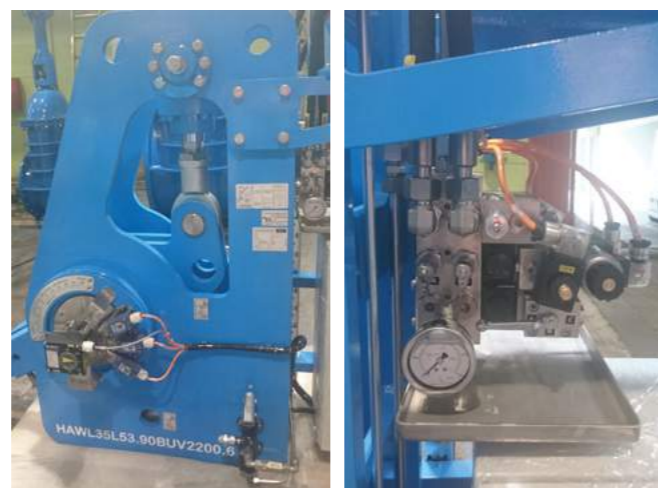
Рисунок 3,4 — Гидропривод HAWL «собственной персоной»
